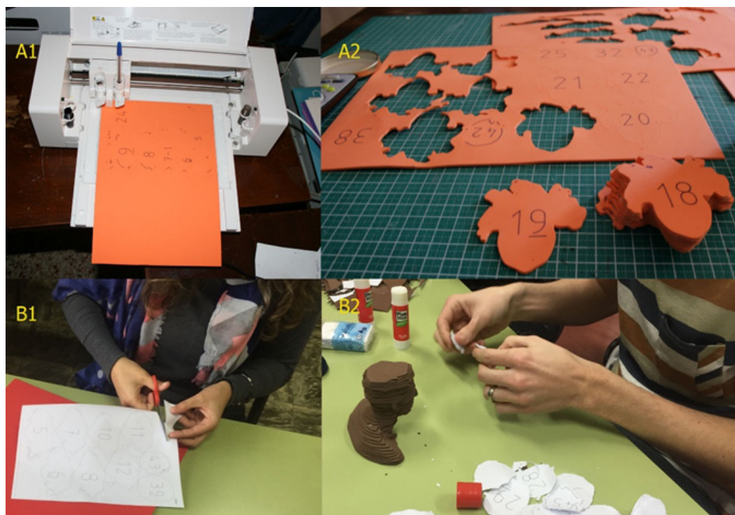
Figura 5. A1: Corte automatizado con plotter de corte. A2: Montaje tras corte con plotter. B1: Corte manual con tijeras. B2: Montaje tras corte con tijeras. (Fotografía del autor).
